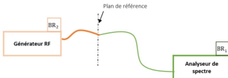
Figure III-15 : Mesure de la PIRE : 2 ème étape.
