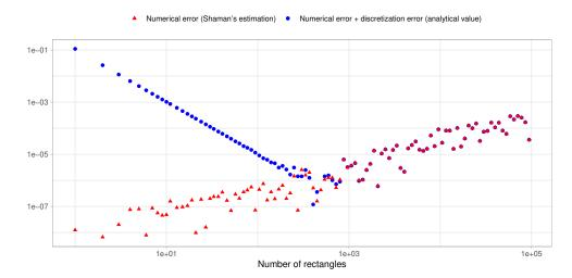
Figure 10.1: valeur absolue de l'erreur en fonction du nombre de rectangles utilisés pour l'intégration du cosinus entre 0 et  $\frac{\pi}{2}$  en utilisant la méthode des rectangles. Les deux axes sont représentés en échelle logarithmique.
