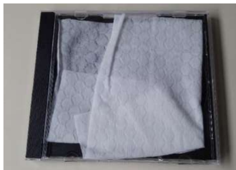
Figure 16 : Version publiée et utilisée comme référence du capteur électrostatique de poussières en position fermée
