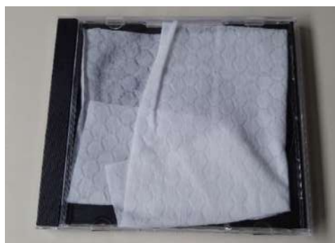
Figure 16 : Version publiée et utilisée comme référence du capteur électrostatique de poussières en position fermée
