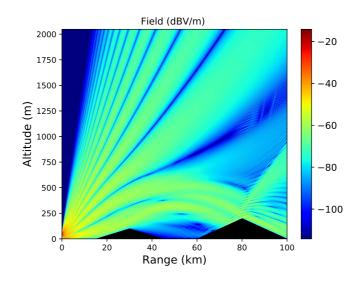
Figure C.2: Champ électrique (dBV/m) calculé avec DSSF.
