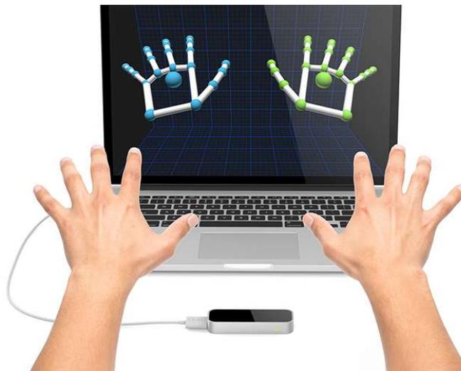
Figure 40 - Suivi des mains par le Leap Motion
