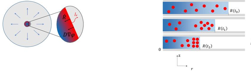
FIGURE 4.6 – Schéma d'une goutte de mélange vue de haut. Le dégradé de couleurs indique la concentration en soluté. Le ménisque de la goutte est le siège de plusieurs mécanismes de transport (évaporation, diffusion massique, etc.).
