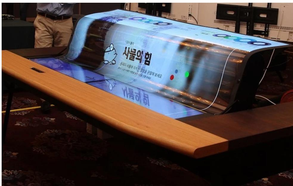
FIGURE 3.40 – Photographie d’un écran OLED (pour Organic Light-Emitting Diode en anglais) composé d’un matériau polymérique conducteur. Source de cette image [ici](#).
