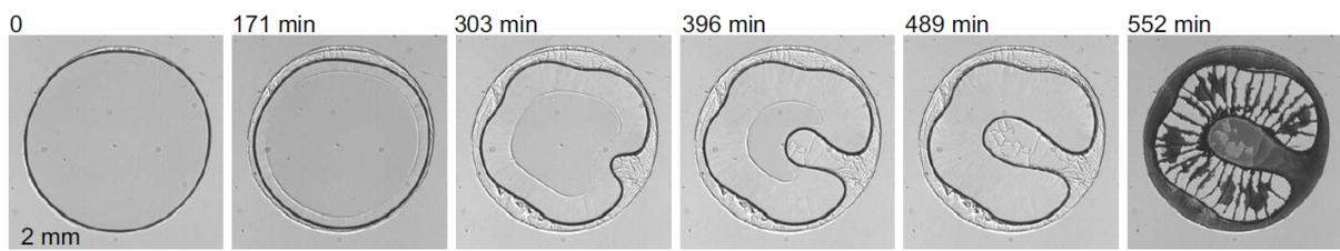
FIGURE 4.2 – Série d'images montrant le séchage confiné d'une goutte de la même solution colloïdale. Images issues des travaux de J. Leng [187]
