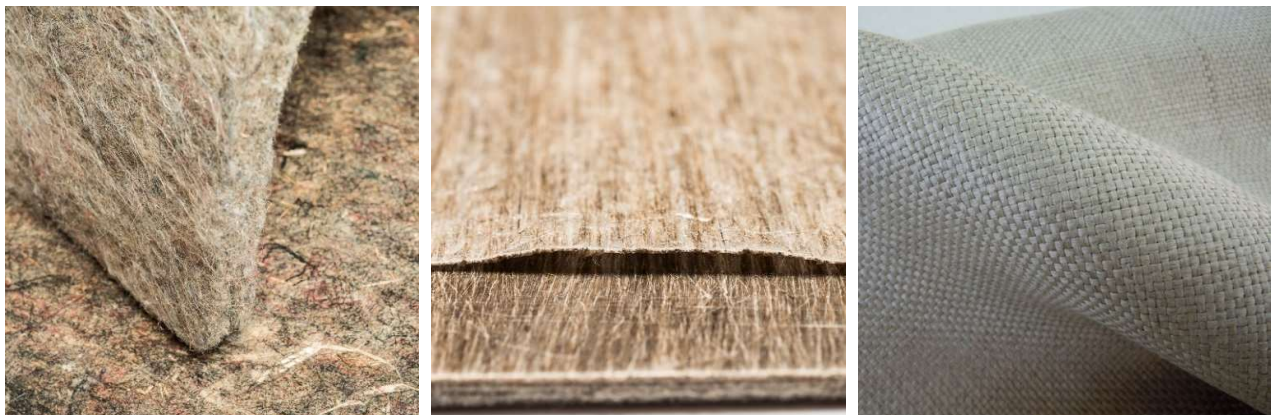
Figure 1.4 : Formes commerciales de différents renforts de fibres de lin pour composites : a) mat de fibres [18]; b) renfort unidirectionnel [50]; c) renfort tissé [51]
