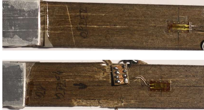
Figure 2.8: Rupture des éprouvettes 0_P2E2 et 0_P2E4
