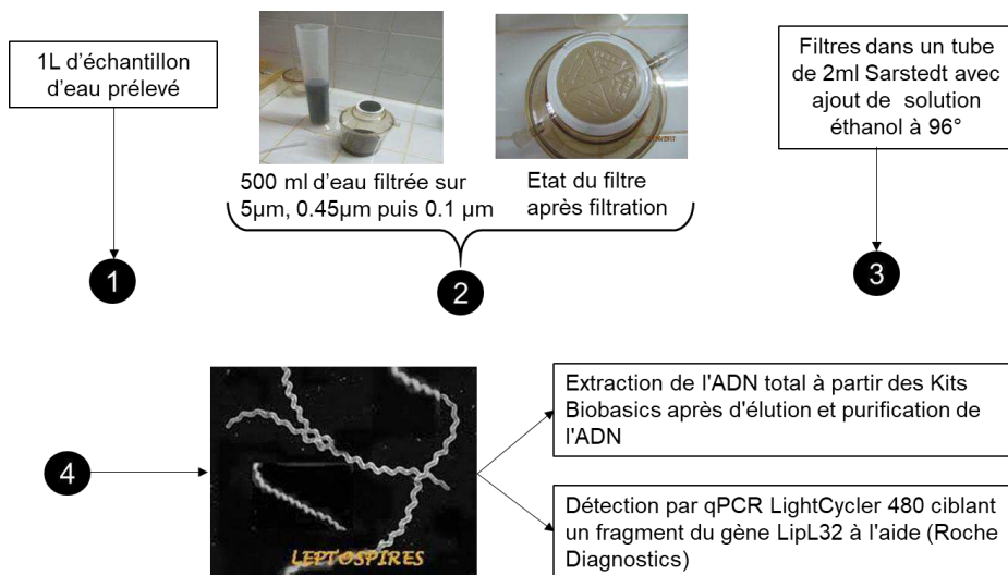
Figure 17 : Etapes relatives à la méthode simple de détection des bactéries leptospires
