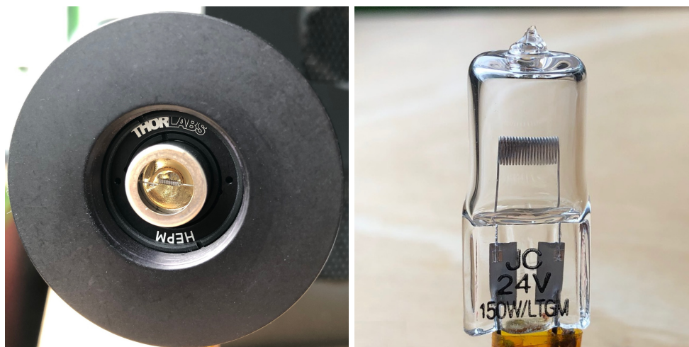
Fig. 5.7 : Image des lampes QTH utilisées comme sources lumineuses. À gauche : la lampe de 7 W dans son radiateur. À droite : la lampe de 75 W.
