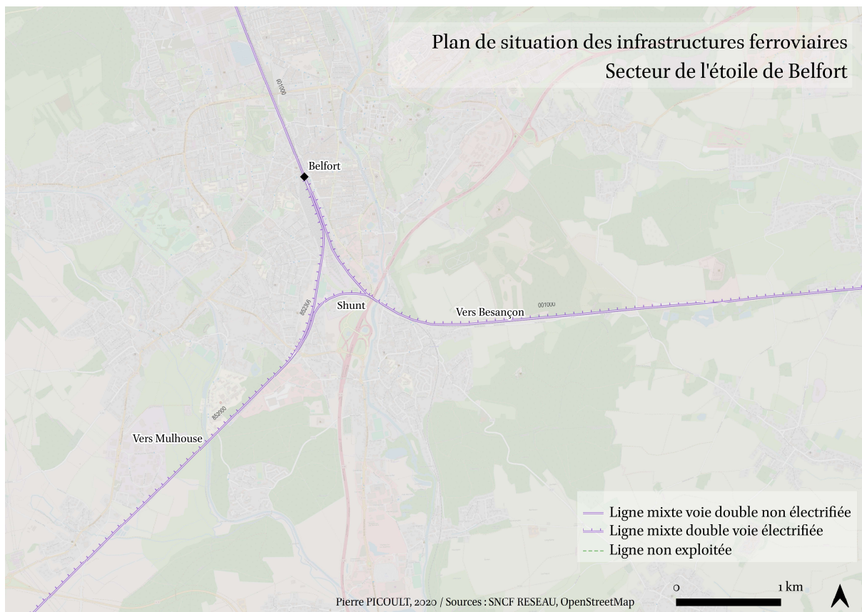
Figure 37 - Zoom sur le nœud de Belfort : le raccordement permet de raccorder les lignes vers Mulhouse à l'est et vers Montbéliard à l'ouest sans desservir la gare de Belfort. (Pierre PICOULT, 2019 – sources : SNCF RESEAU, OpenStreetMap)
