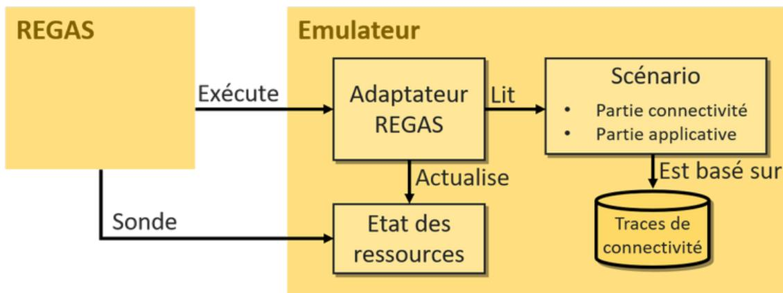
FIGURE 6.3 – Fonctionnement de REGAS avec l'émulateur.
