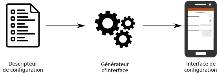
FIGURE 5.3 – Processus de génération d’une interface personnalisée
