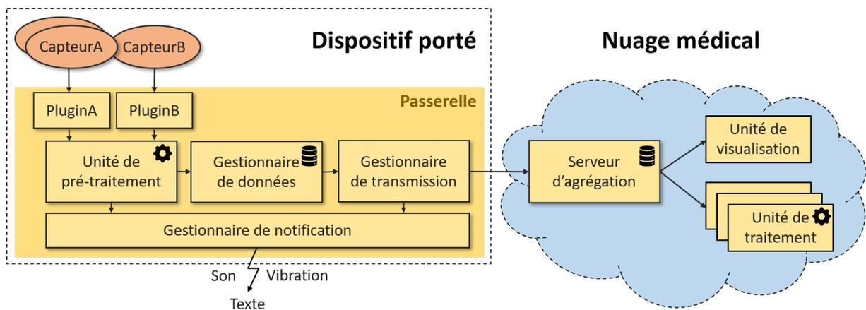
FIGURE 5.1 – Architecture logique des composants de la plateforme SHERPAM.
