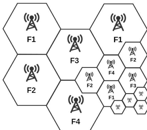
FIGURE 3.3 – Représentation de l'allocation des fréquences dans une structure de réseau cellulaire.
