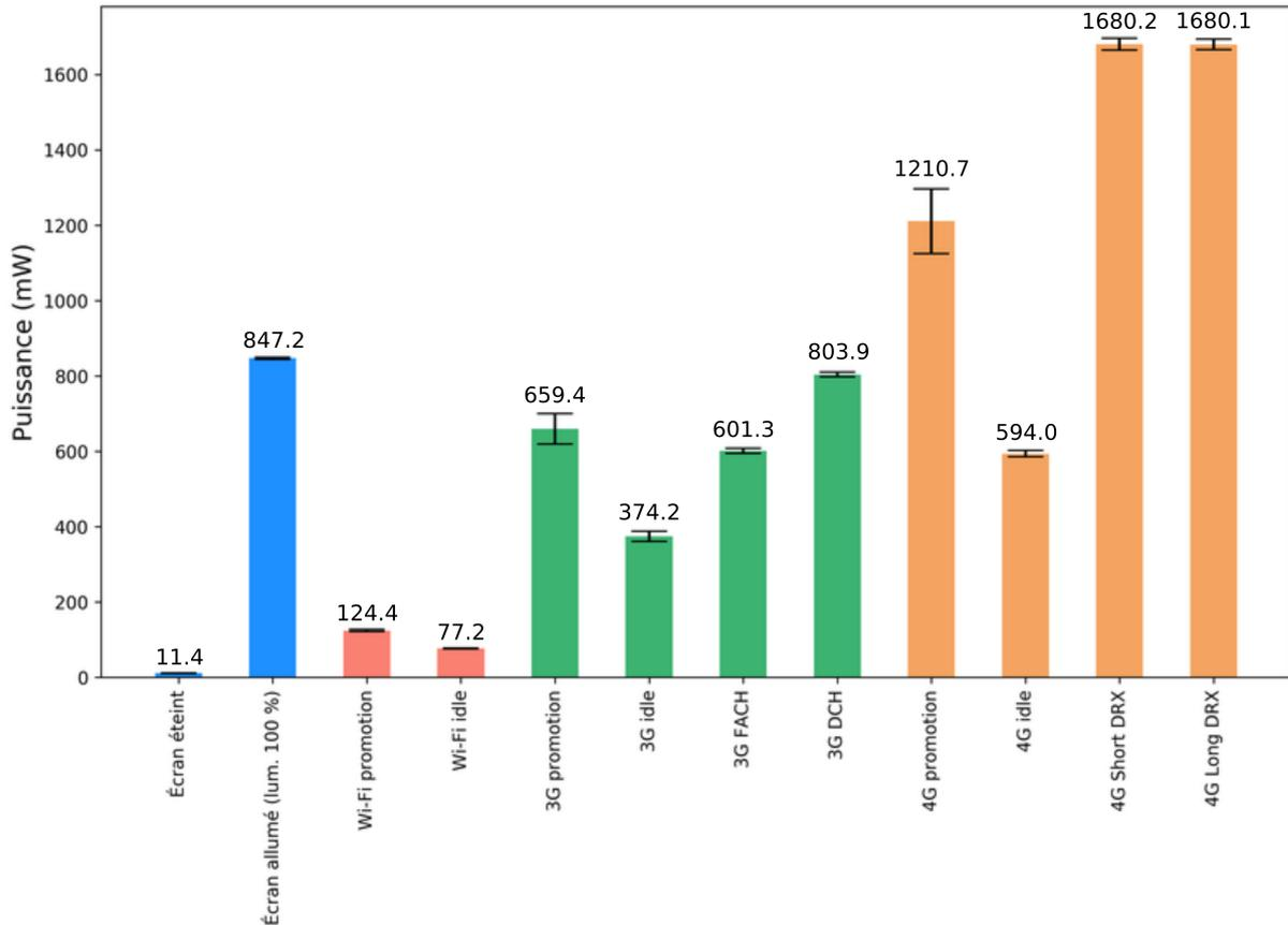
FIGURE 4.1 – Puissances consommées par les technologies Wi-Fi, 3G, et 4G (mesures réalisées sur un smartphone LTE) [74].
