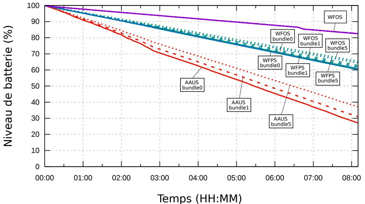
FIGURE 6.9 – Comparaison de l'évolution du niveau de batterie entre les stratégies et selon différents modes de transmission dans le scénario n°2.
