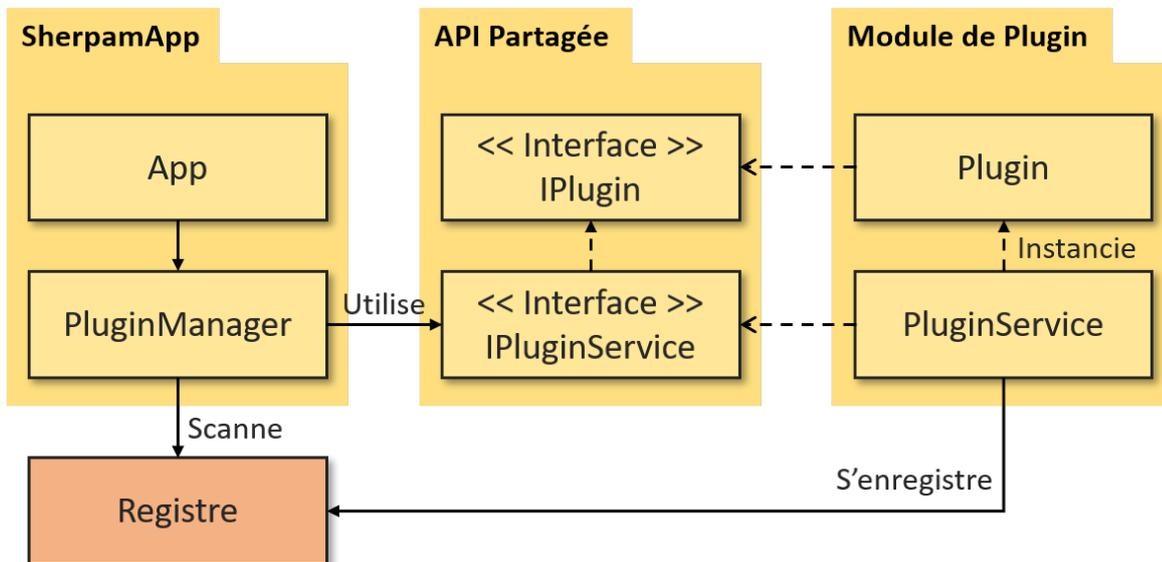
FIGURE 5.2 – Architecture du mécanisme de plugins.
