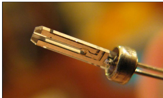
Figure 18 Diapason en quartz utilisé dans l'industrie horlogère.
