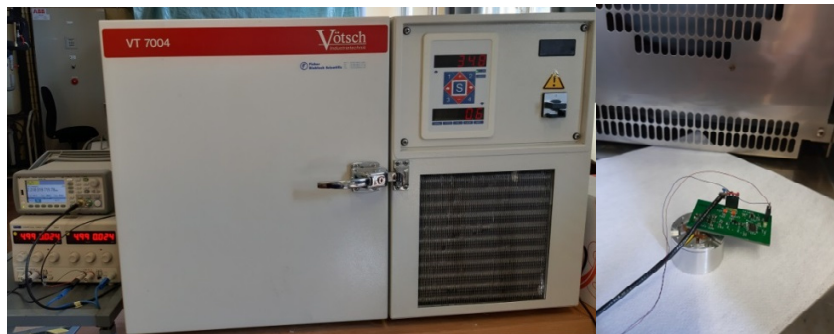
Figure 145 Photographie du dispositif expérimental de la mesure de la sensibilité thermique : a) enceinte climatique Vötsch, b) intérieur de l'enceinte.
