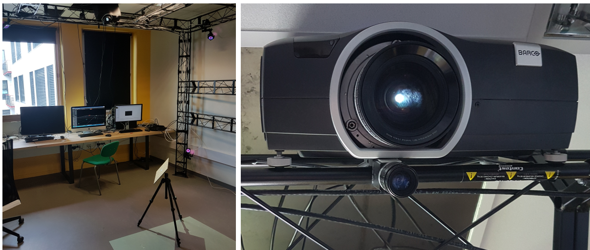
FIGURE A.1: À gauche : une grille de marqueurs est placée dans le champ de projection pour la calibration semi-automatique. À droite : la caméra fixée sous le projecteur voit les marqueurs qui reflètent la lumière envoyée par le projecteur.
