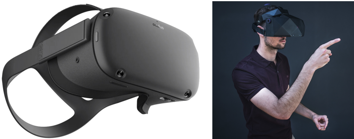
FIGURE 1.7: À gauche : l'occulus Quest, les caméras permettent la capture de mouvement sans nécessiter de dispositif externe. À droite : le Xtal de Vrgineers, offrant une résolution 5K et un champ de vision de 180°.
