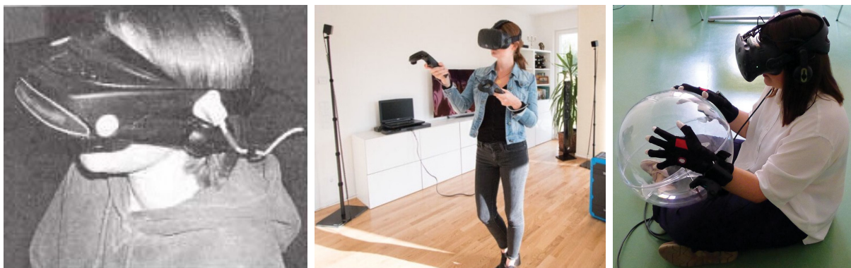
FIGURE 1.6: À gauche : le casque de RV testé par Patrick et al., utilisant un Visette Pro pour l'affichage et un Ascention SpacePad pour la capture de position (source : [111]). Au milieu : le Vive de HTC sorti en 2016, avec ses contrôleurs isomorphes et les bases permettant la capture optique. À droite : la sphère tangible utilisée par Englmeier et al. (source : [50]).
