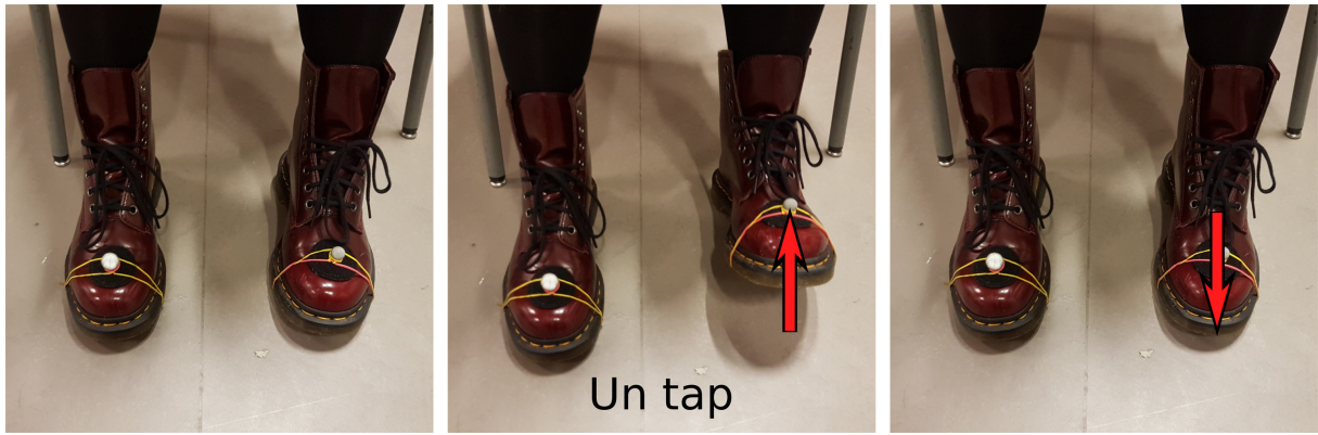
FIGURE 5.4: Des marqueurs sont attachés aux chaussures de la participante pour détecter les “taps”.
