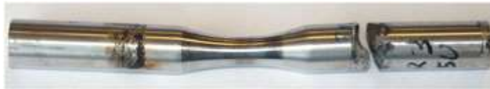
Figure 1.37 : Rupture par fretting fatigue à l'extrémité d'une éprouvette en AA2024-T351 lors d'un essai de fatigue (J. T. Maximov, Anchev, Dunchev, et al., 2017)
