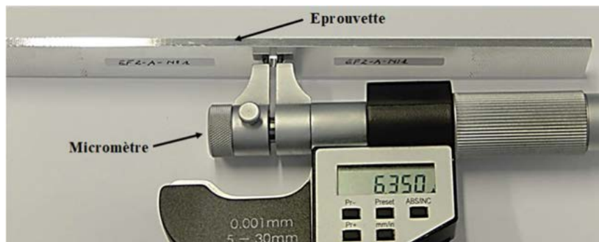
Figure 2.15 : Mesure de Diamètre de trou dans le sens longitudinal de l'éprouvette
