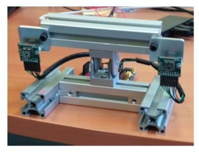
Figure 1: Le système stéréo composé de deux caméras Lepton 2 placées en parallèle.
