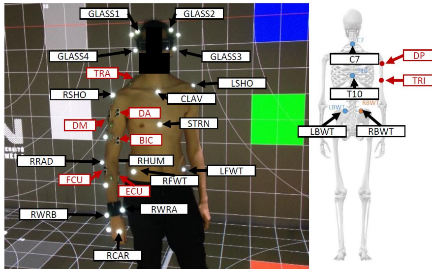
FIGURE 5.3 – Emplacement des marqueurs infrarouges pour la capture de mouvement (en noir) et des électrodes EMG (en rouge) sur la vue ventrale (à gauche) et dorsale (à droite).
