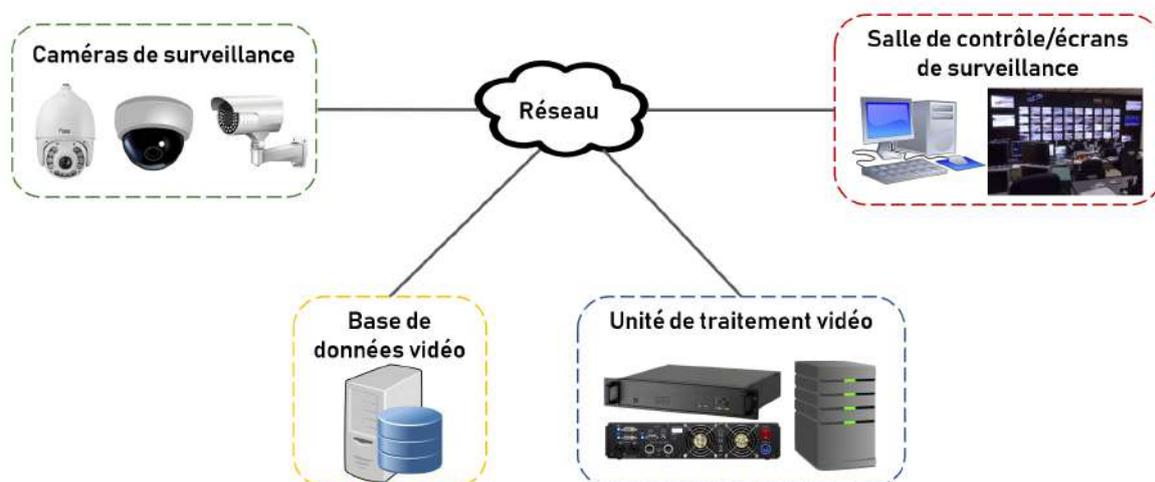
FIGURE 2.1 – Schéma d'un système de vidéosurveillance automatique.
