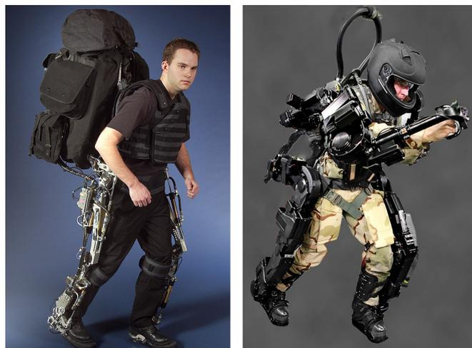
FIGURE 2.2.2 – Illustration de deux exosquelettes militaires : à gauche HULC (Human Universal Load Carrier - Ekso Bionics & Lockheed Martin), à droite XOS/XOS2 (Sarcos/Raytheon)
