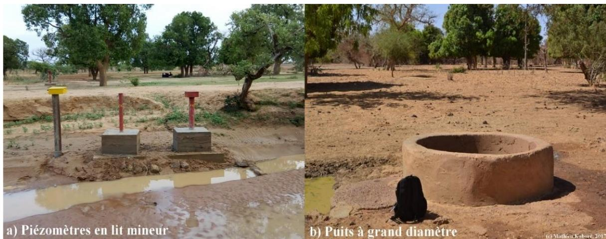
Planche I-5. Equipement de suivi de la ressource en eau souterraine. (a) Vue partielle du transect, indiquant les piézomètres implantés dans le lit mineur du Bilanpoanga, permettant le suivi du processus de recharge (Koïta et al., 2017). (b) Puits à grand diamètre. Les photos proviennent de prises de vue de terrain effectuées en 2017.
