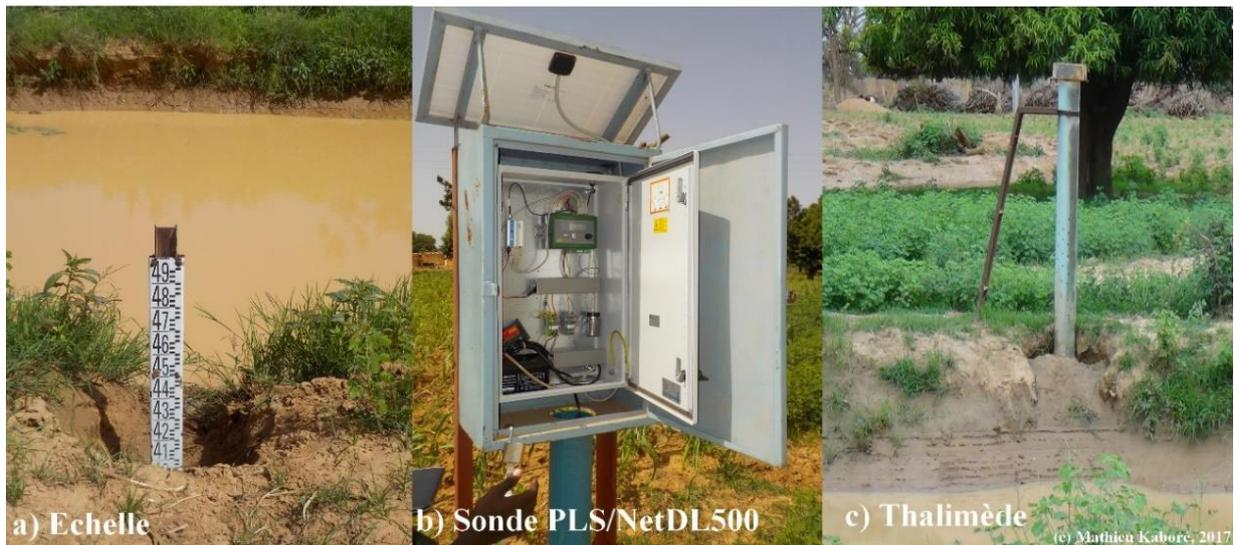
Planche I-4. Photos des équipements pour le suivi des écoulements de surface. (a) Echelle de lecture directe. (b) Sonde OTT PLS (Pressure Level Sensor) associée à un boîtier d'acquisition de type OTT NetDL500. (c) Thalimède. Les photos proviennent de prises de vue de terrain en 2017.
