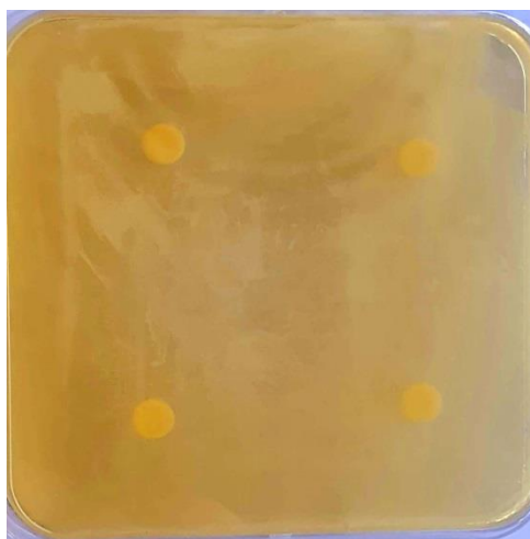
Figure 50 : Méthode de diffusion sur disque avec le propan-2-ol à 99.5%
