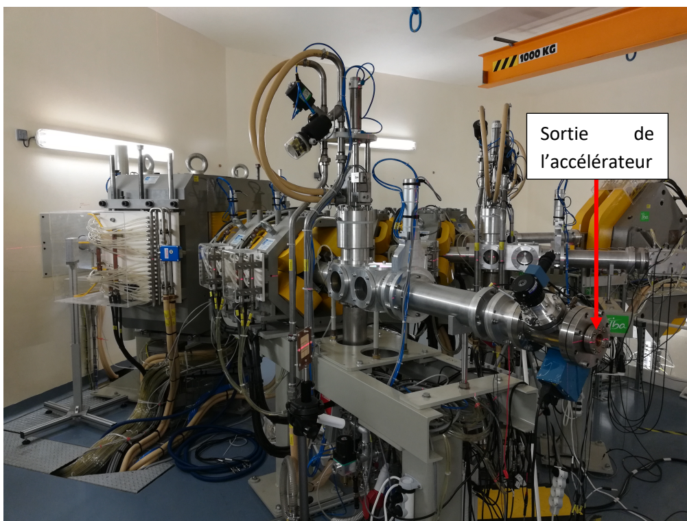
Figure 84 - Sortie du faisceau de la casemate d'irradiation utilisée pour l'irradiation proton des détecteurs NIR.
