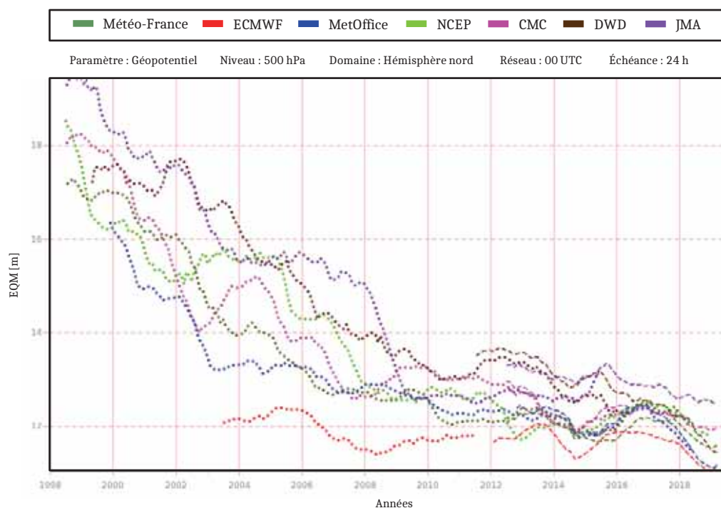
FIGURE 2: Évolutions temporelles des erreurs quadratiques moyennes annuelles (EQM) (moyennes glissantes) de la prévision à 24 h d'échéance du réseau de 00 UTC du géopotential à 500 hPa (m) par rapport aux mesures des radiosondages sur l'hémisphère nord de 1998 à 2019 pour différents modèles globaux : Français (en kaki), CEPMMT (en rouge), Anglais (en bleu), Américain (en vert), Canadien (en rose), Allemand (en marron) et Japonais (en violet). [D'après ECMWF ( https://apps.ecmwf.int/wmolcdnv/scores/time_series/msl )].
