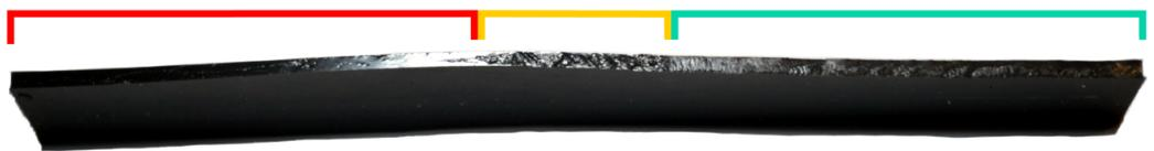
FIGURE 2.20: Faciès de rupture d'une éprouvette de cisaillement pur de SBR non chargé. De droite à gauche : entaille initiale (vert), faciès rugueux (jaune), faciès lisse (rouge).
