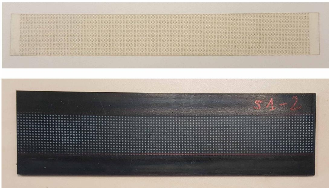
FIGURE 3.2: Réalisation des marqueurs visuels sur éprouvette de cisaillement pur. Pochoir utilisé (haut) et éprouvette marquée (bas).
