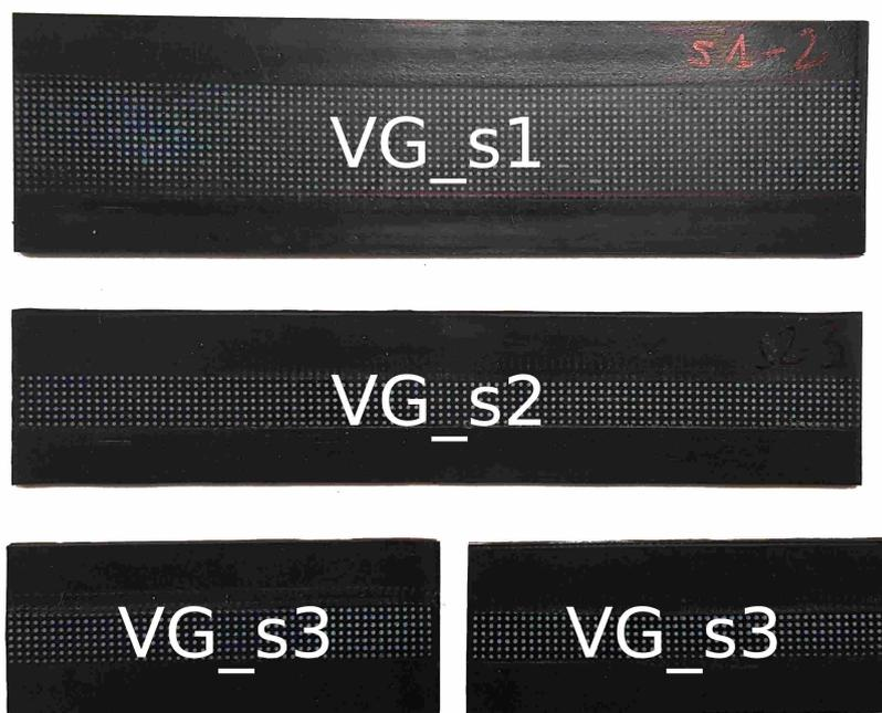
FIGURE 4.14: Éprouvettes de cisaillement pur de tailles différentes utilisées pour évaluer l'effet de la taille d'éprouvette sur les propriétés de fissuration. Les différentes dimensions sont indiquées dans le texte.
