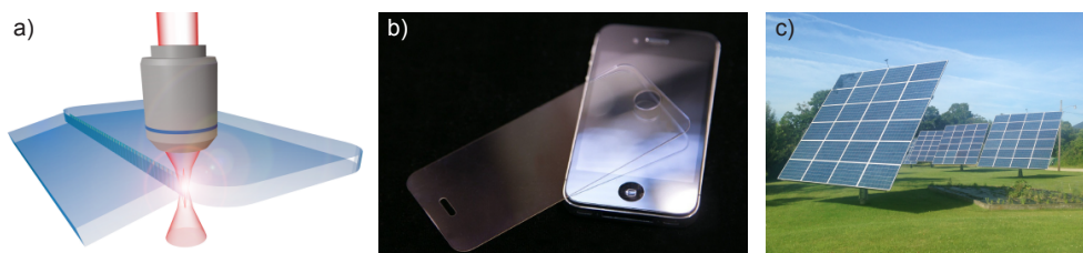
FIGURE 3.22 – a) Vue schématique d'une découpe de verre fin au laser ; b) Verre de protection d'un smartphone, 300 \mu\text{m} d'épaisseur ; c) Panneaux solaires, dont la vitre de protection possède une épaisseur de 3 à 4 mm. (b et c, images Creative Commons ).
