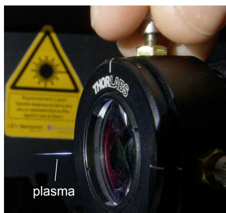
FIGURE 5.10 – Formation d'un plasma lumineux de 8 mm de longueur dans l'air à E_p = 2,5 mJ et pour des impulsions de 43 fs à l'entrée du système.
