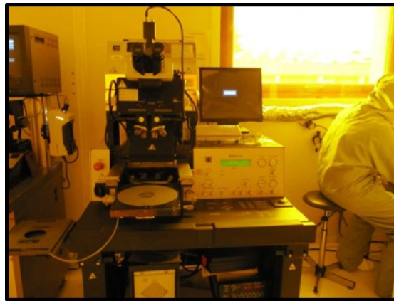
FIGURE 3.3 – Photographie de la salle blanche de la plateforme NanoRennes utilisée pour la réalisation des circuits photoniques par photolithographie dans l'UV profond.
