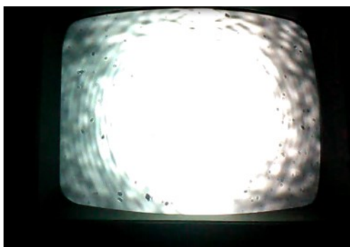
FIGURE 3.10 – Photographie de l'écran relié à la caméra CCD pour l'injection. On y voit le mode TE_{00} en sortie de guide d'onde.
