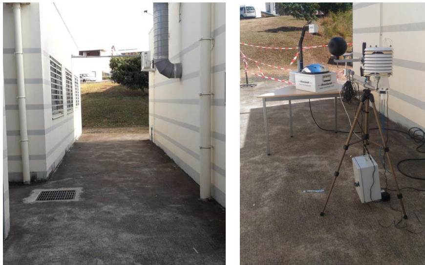
Figure 3.16 : Expérimentation déployée en extérieur dans une configuration de type canyon urbain simplifiée
