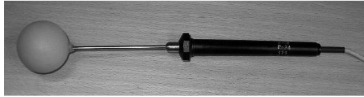
Figure 3.7: Capteur globe gris adapté aux études de confort en extérieur (Thorsson et al., 2007)
