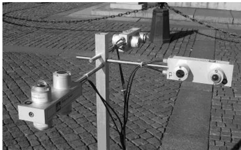
Figure 8. Trois radiomètres nets (Kipp et Zonen, CNR 1), chacun mesurant séparément les quatre composantes du rayonnement : les flux de rayonnement entrant et sortant en ondes courtes et en ondes longues [Thorsson 2007]
