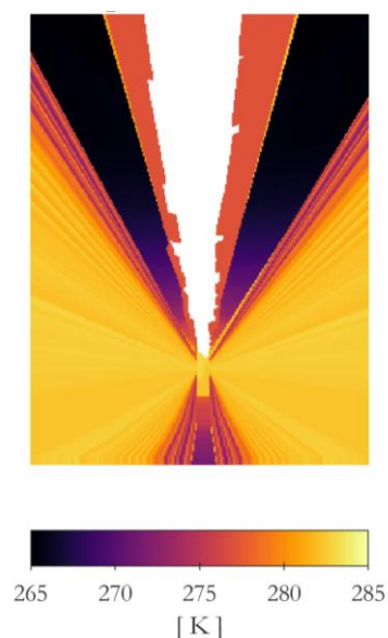
Figure 88. Température réfléchie calculée pour chaque pixel de l'image pour le 19 février 2019 à 22h00
