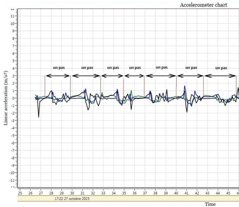
**Figure 3.17** Détection d'un pas à travers l'accélération linéaire
