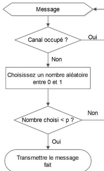
**Figure 2.4** *Le mécanisme CSMA/CA*
