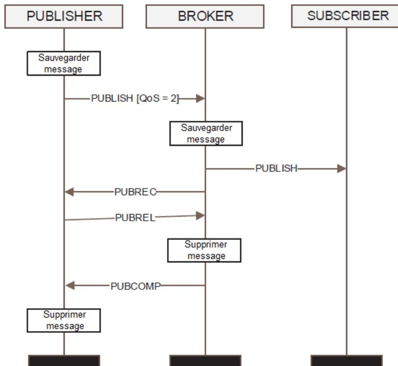
**Figure 3.6** *Exactement une fois la livraison (MQTT QoS =2)*
