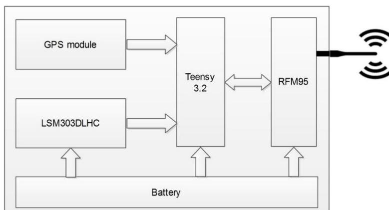
**Figure 3.7** *Architecture du nœud émetteur de la canne*
