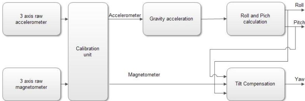
**Figure 3.13** Système de fusion de capteur
