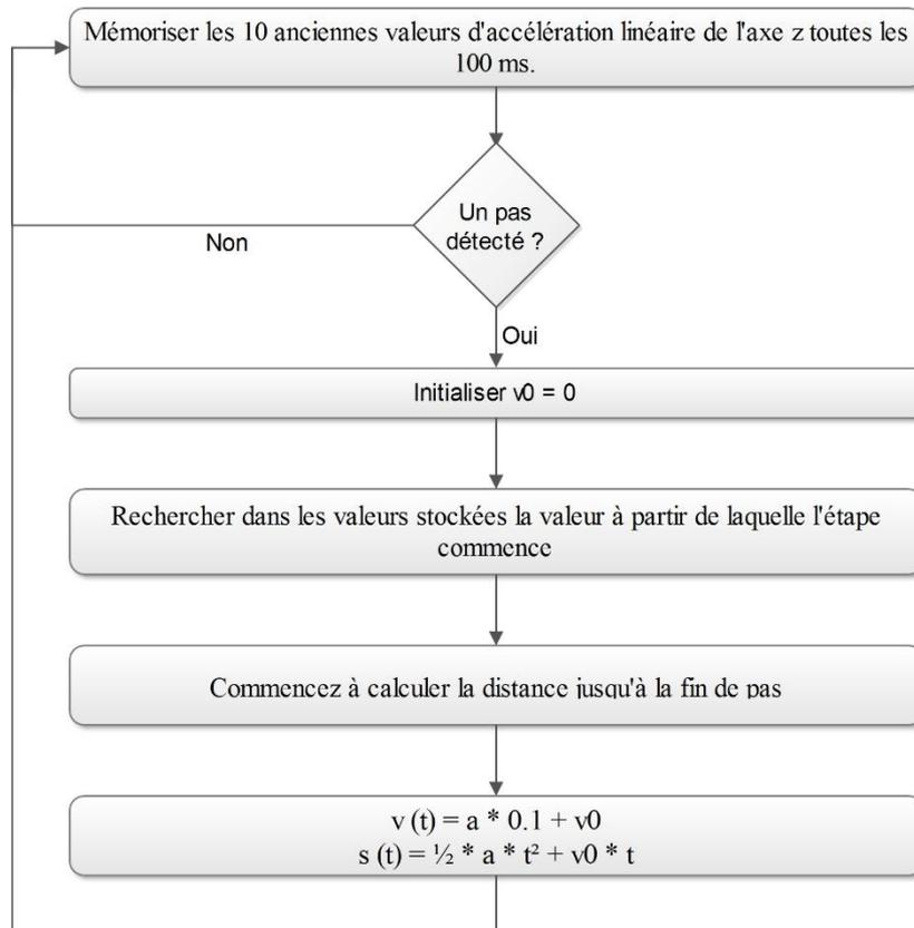
**Figure 3.20** *Algorithme de calcul de la distance parcourue.*
