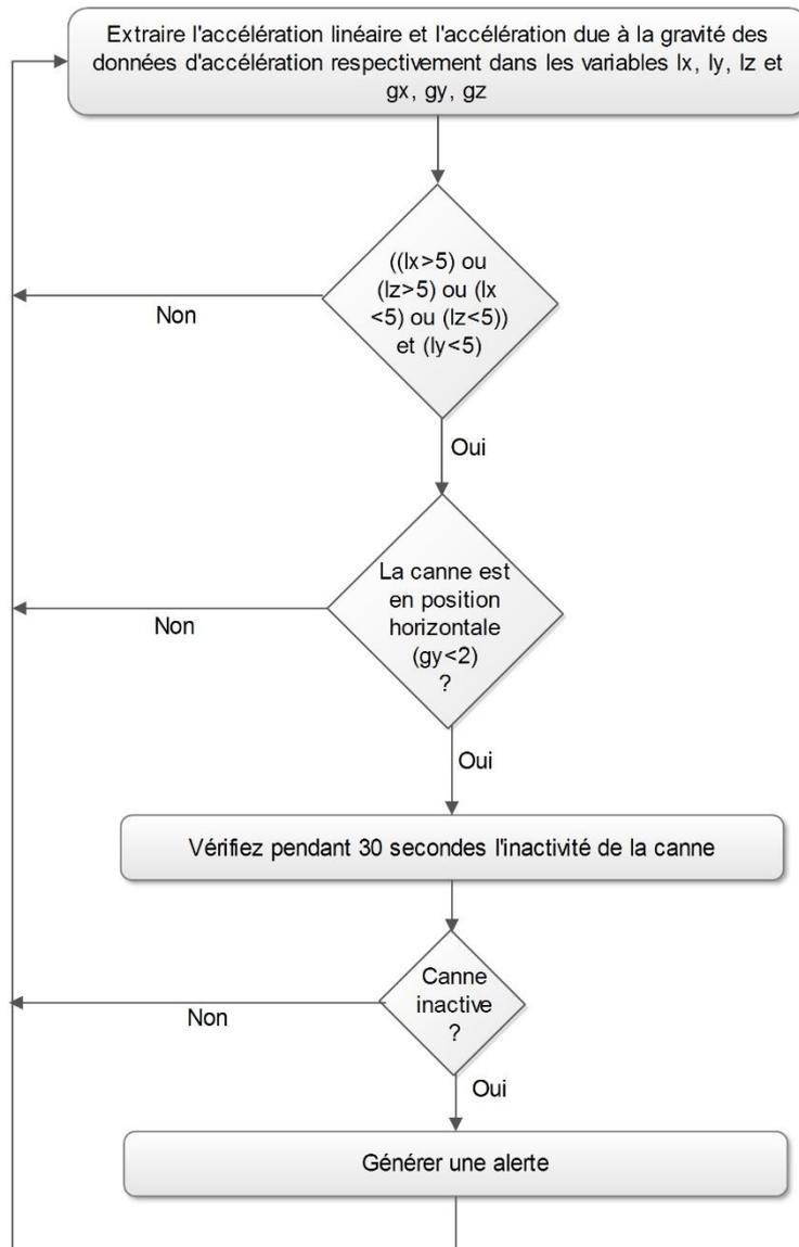
**Figure 3.16** *Algorithme de détection de chute.*
