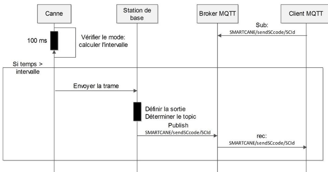
**Figure 3.23** Communication canne avec les objets connectés
