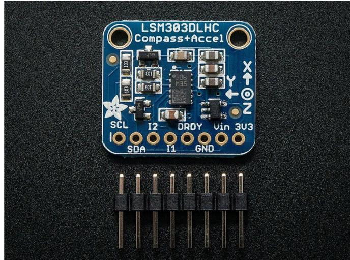
**Figure 3.8** Capteur *lsm303dlhc*
