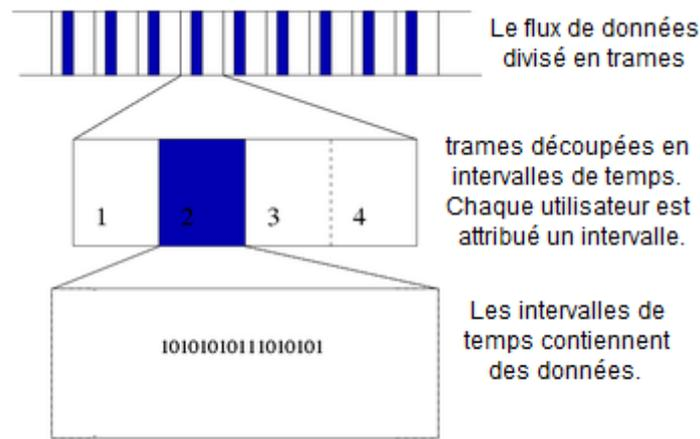
**Figure 2.6** Structure du protocole TDMA
