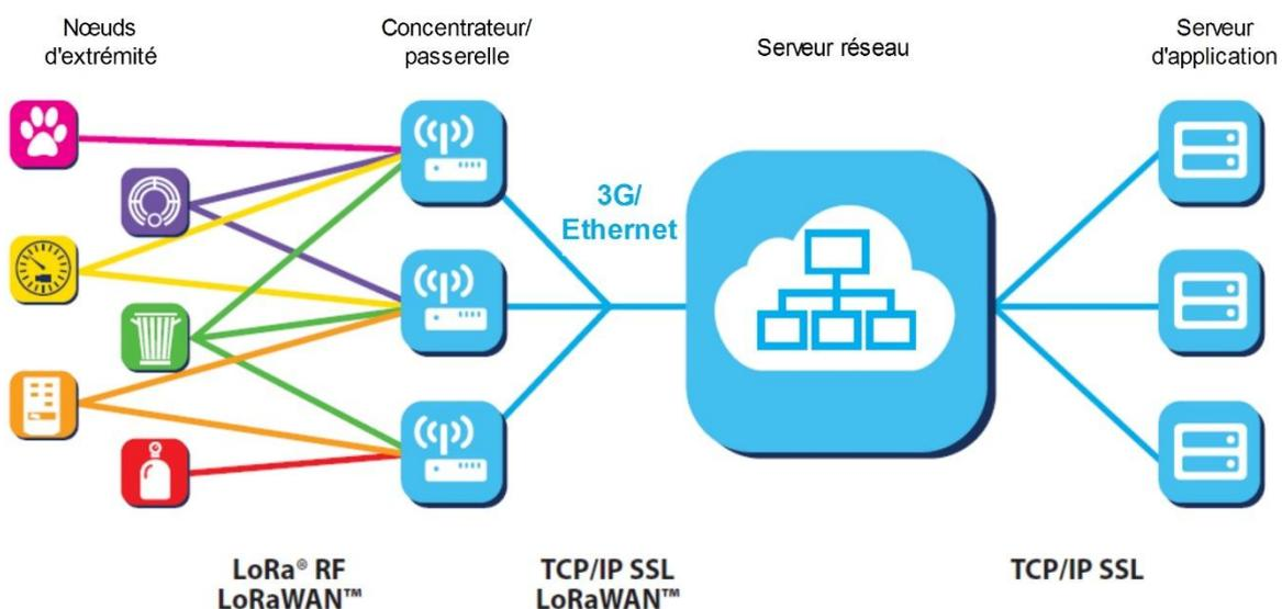
Figure 3.2 Architecture de LoRaWAN [138]
