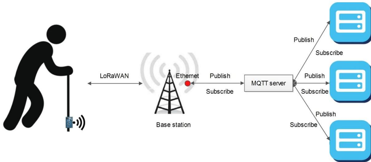
**Figure 3.1** Architecture du système de surveillance
