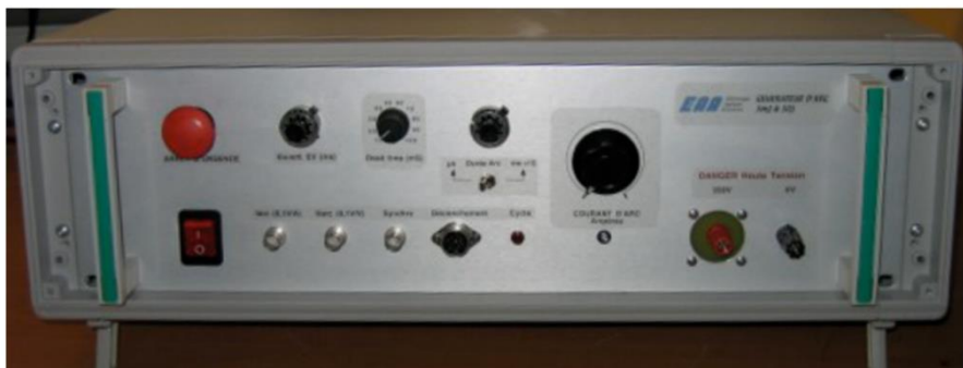
Figure 8-1 : Photo du générateur de décharges électriques.
