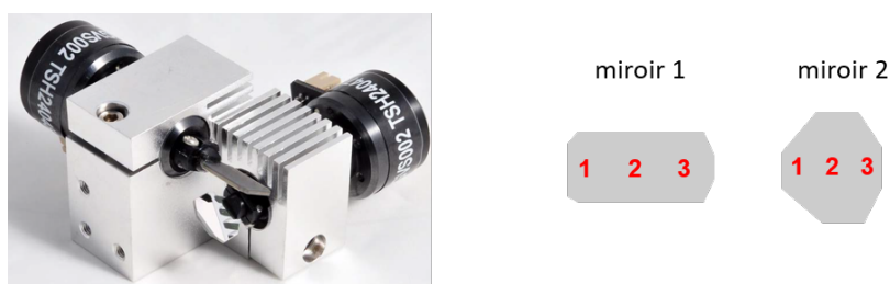
FIGURE 3.10 – À gauche : photographie des miroirs galvanométriques ; à droite : zones analysées des miroirs.
