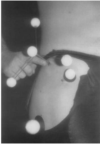
Figure 4 (Gauche): modèle expérimental utilisé par Neptune et Hull (1995). Noter la triade de marqueurs associée à un pin intracortical fixé à l'articulation de la hanche et utilisé comme standard afin de mesurer l'erreur cinématique entraînée par différentes configurations de marqueurs. (Droite) : Position du centre articulaire de la hanche au cours d'un cycle de pédalage à 225 W et 90 RPM. STD : référence basée sur le pin intracortical. TRO : marqueur cinématique placé sur le Grand Trochanter. ASIS : méthode basée sur l'utilisation d'un marqueur placé sur l'épine illiaque antéro-supérieure.
