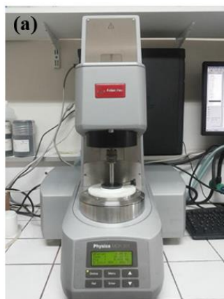
Figure II-12 : (a) Rhéomètre Anton Paar MCR 30, (b) Rhéomètre représentation géométrie plan-plan.
