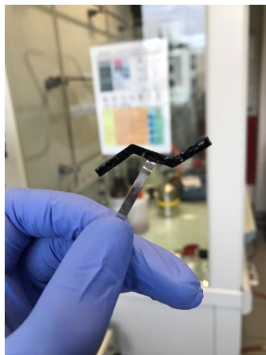
Figure II-2 : Photo électrode de platine recouverte de carbone YP-50F pour cellule en mode flow.
