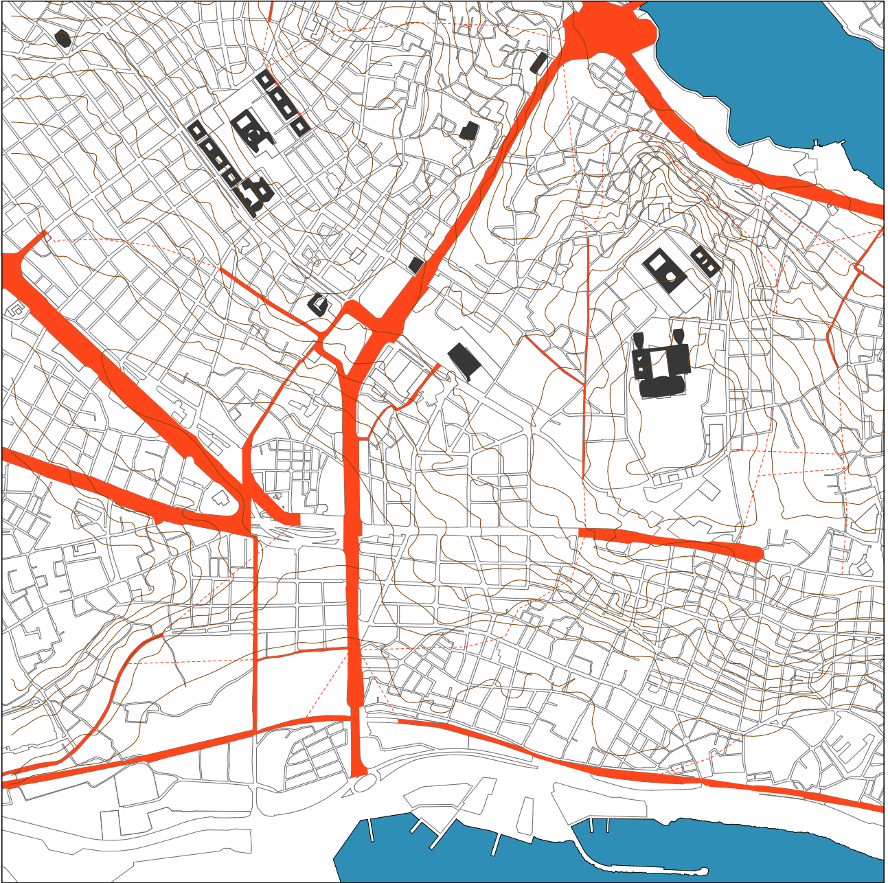
Carte de la persistance des tracés du plan de Prost dans les tracés des voies actuelles. Superposition des tracés du plan de 1937 sur le redessin des tracés actuels en 2015. Cadrage sur la séquence du bd Atatürk. Carte Lucie Moneteau et Tiphaine Monier, sous la direction de L. Hodebert.
