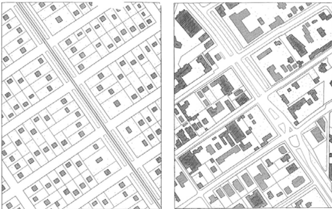
Arturo Soria y Mata, La cité linéaire, Madrid, planches d'analyse montrant l'insertion du dispositif dans le tissu urbain en 1882 et en 1996, dessin Valérie Astié ( Le parkway, dispositif métropolitain , 1996, fig. 89 et 92).
