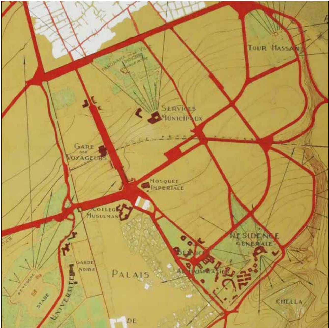
17 Henri Prost, Plan d'aménagement de la ville de Rabat, plan des voies et des espaces libres, 1915, Fonds Prost, AA/CAPA/AA XX°, 343 AA 202/5. Cadrage sur la séquence centrale du plan, éch. 1/12 500°, détails voir atlas.
