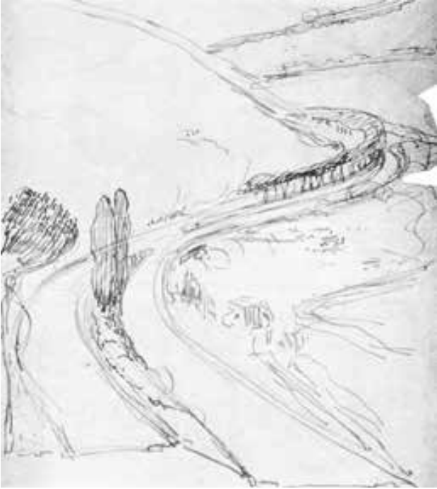
39 Henri Prost, Plan d'aménagement de la côte d'azur varoise, Le parkway à flanc de coteau, vers 1923 ( Urbanisme , n°88, 1965, p. 19). La légende indique "Croquis d'Henri Prost montrant comment les deux courants de circulation d'une voie peuvent serpenter dans un terrain accidenté".
