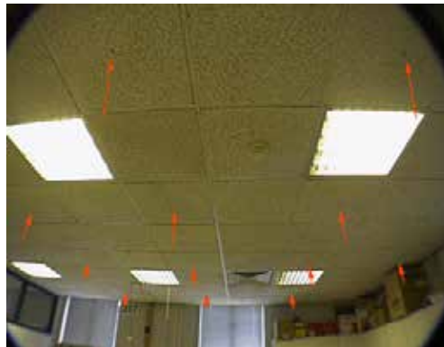
Figure 1.14- Système Active BAT: Les récepteurs ultrasons, figure inspirée des travaux de (TSENG, 1998)
