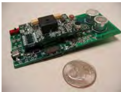
Figure 2.3 Un nœud Cricket, figure inspirée des travaux de(BODHI, 2005)
