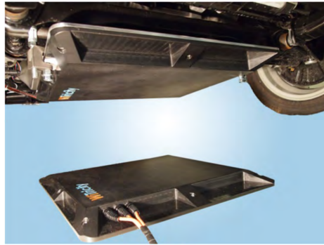
Figure I.18 – Système "WiT 3300 kit" de recharge sans contact [53].
