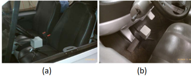
Figure I.24 – Position des deux sondes Narda, (a) sur le siège conducteur et (b) sur le plancher [56].
