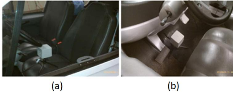
**Figure I.24** – Position des deux sondes Narda, (a) sur le siège conducteur et (b) sur le plancher [56].
