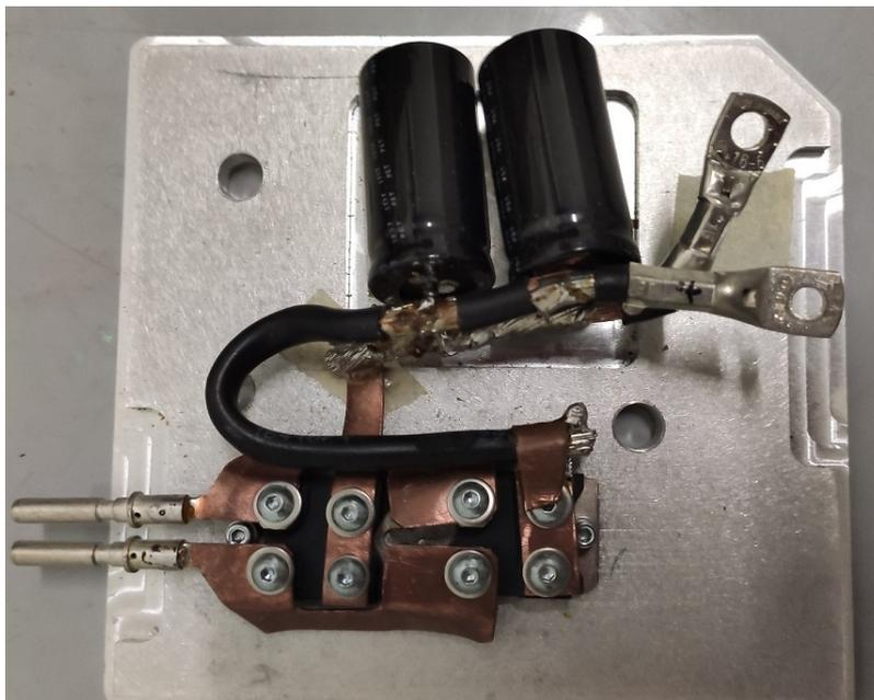
Figure IV.12 – Redresseur utilisé dans le banc d'essai.
