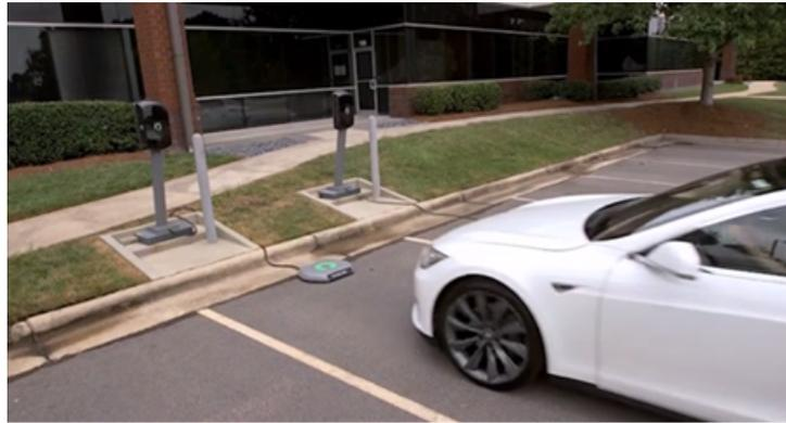
**Figure I.20** – Système "Plugless Power" [57].
