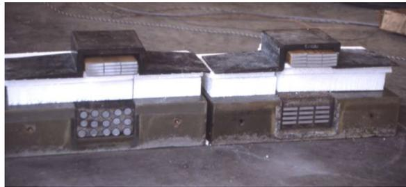
**Figure I.21** – Vue de coupe transversale d'un tronçon de piste du projet "PATH" [60].
