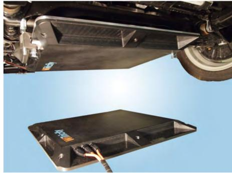
**Figure I.18** – Système "WiT 3300 kit" de recharge sans contact [53].
