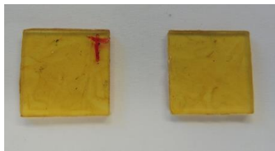
Figure 4-27 : Matériaux hybrC (1 : 2) témoin (à gauche) et ayant subi les conditions d'humidité élevée (50 °C, 50 %HR, 24 heures) (à droite) réparés sous presse à compression (110 °C / 15 min / 60 bars).
