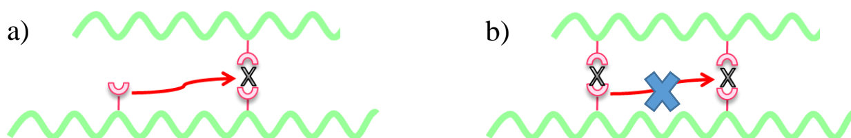
Figure 3-13 : a) Cas d'un échange possible par la présence de fonctions pendantes libres et b) cas d'un échange impossible (taux d'hybridation Ti : -CO_2H de 1 : 1).
