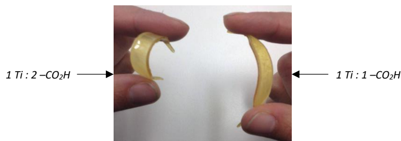
Figure 2-47 : Influence de la rigidité au toucher d'échantillons des matériaux hybrC (1 : 2) et hybrC (1 : 1) sous environ la même contrainte.
