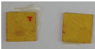
Figure 4-28 : Matériaux hybrC (1 : 2) témoin (à gauche) et ayant subi les conditions « extrêmes » d'humidité (50 °C, 90 %HR, 5 heures) (à droite) réparés sous presse à compression (110 °C / 15 min / 60 bars).
