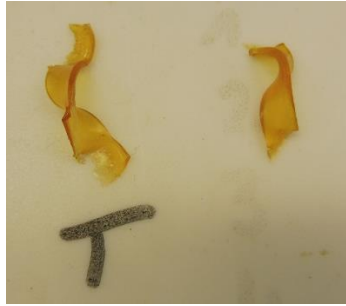
Figure 4-29 : Matériaux hybrC (1 : 2) témoin noté « T » (à gauche) et ayant subi les conditions d'humidité élevée (50 °C, 50% HR, 24 heures) (à droite) suite à une déformation imposée.
