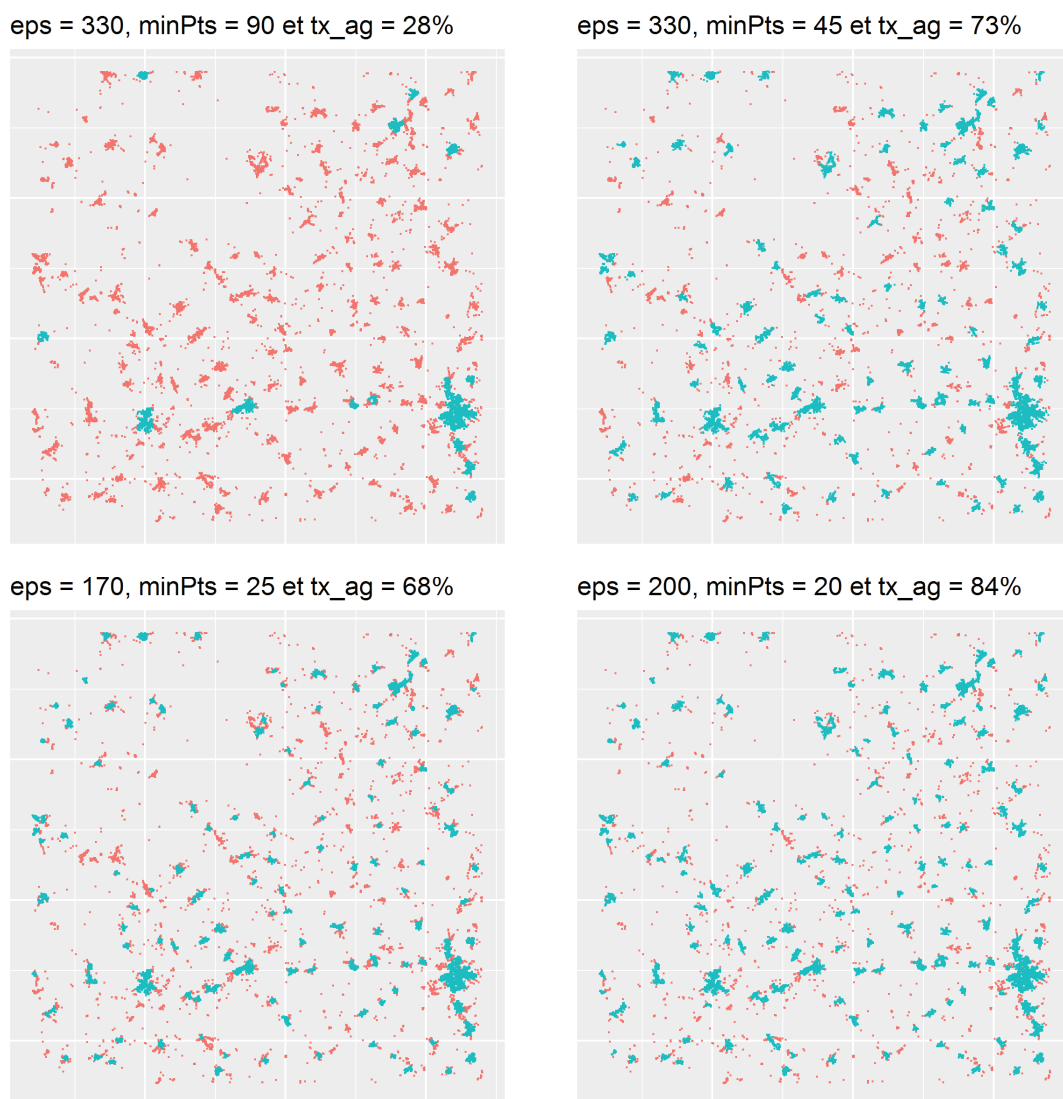
FIGURE 2.16 – Analyse de sensibilité (en bleu les points agrégés et en rouge les non agrégés) d’une zone contenue dans le département de l’Eure. La part des bâtiments appartenant à une zone agrégée est très sensible aux paramètres choisis. On constate à partir de cet exemple, la difficulté à définir de façon univoque la notion de village.
