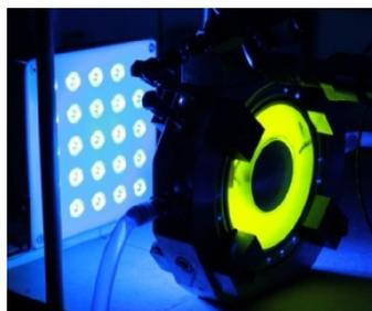
FIGURE 4.3 – Photographie du photoréacteur d'étude avec à l'intérieur le système photocatalytique étudié dans ce chapitre où l'on voit une coloration jaunâtre due à la fluorescence de l'éosine Y.
