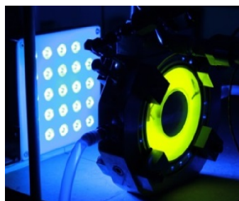
FIGURE 4.3 – Photographie du photoréacteur d'étude avec à l'intérieur le système photocatalytique étudié dans ce chapitre où l'on voit une coloration jaunâtre due à la fluorescence de l'éosine Y.
