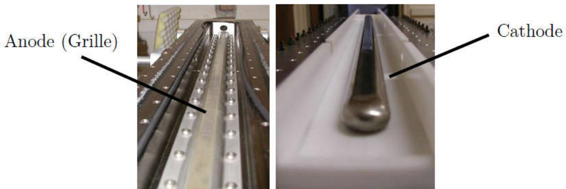
Figure 44 : Photographies des électrodes du réacteur UV 510.
