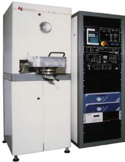
FIGURE II.2 – Bâti de pulvérisation du laboratoire : AC-450 par Alliance Concept ®
