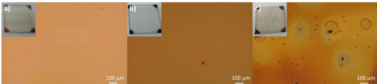
Figure III-4: Image de microscopie optique de films déposés à partir d'une solution d'o-xylène. a) PC 60 BM 20 mg/ml, b) DPPDTS-C16 5 mg/ml et c) DPPDTS-C16 1:4 PC 60 BM (5 mg/ml en DPPDTS-C16).
