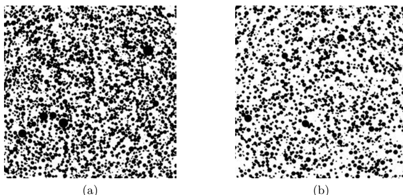
FIGURE 5.11 – Coupes de volumes seuillés avec une taille de voxel de 15 \mu\text{m} pour les formulations a) W75 et b) W100
