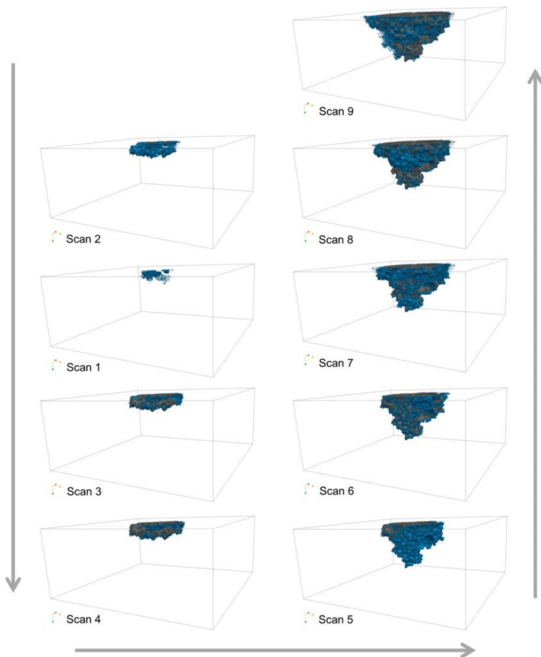
FIGURE 4.12 – Rendu 3D des résidus seuillés pour W75 à chacune des étapes de chargement
