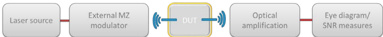
Figure 46. Schéma symbolique de la mesure par diagramme de l'œil : Un modulateur de Mach-Zehnder module la source laser et envoie le signal sur la plaque silicium avec un coupleur à réseau. Après être passé par le Device Under Test (DUT) le signal est recouplé dans une fibre optique, amplifié et détecté.
