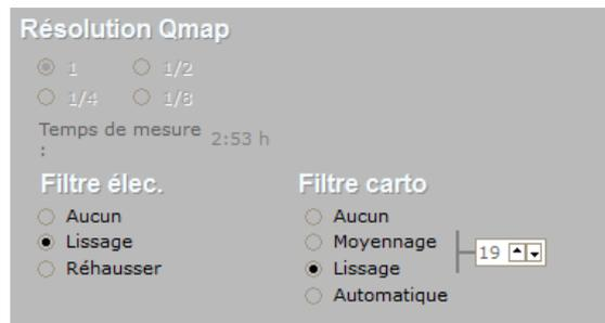
Figure 45 : Traitements de l'image possibles dans Esprit 1.9™.
