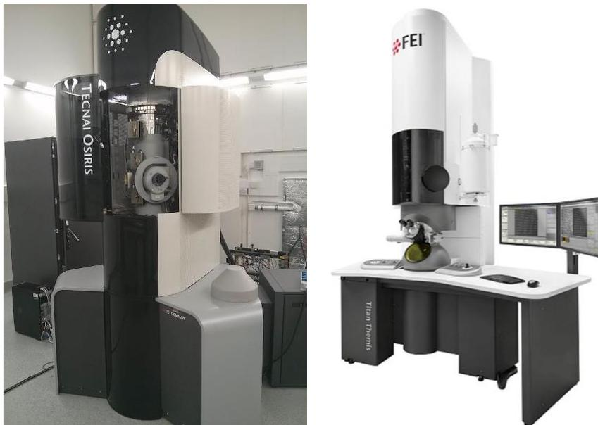
Figure 24 : Photographies de microscopes TFS optimisés pour la caractérisation TEM analytique. (a) Le Tecnai Osiris, (b) le Titan Themis.
